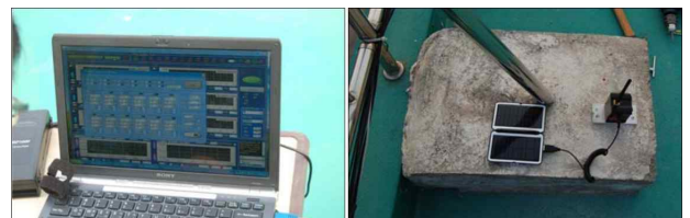
(그림 2) (계측시스템 (데이터수집장치, 가속도계))
